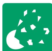
Magnete können beim Zusammenprallen in scharfkantige Teile splittern. Jeder Zusammenprall sollte deshalb vermieden werden.
